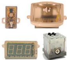
Figura 4 – Dispositivos de salida del PicoCricket: Luces multicolores, caja de música, exhibidor de números y motor.
