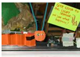
Figura 10 - Gusano medidor cuyo movimiento se dispara con un sensor de luz. El mensaje dice: "Acércate a la luz y veras qué pasa!"
