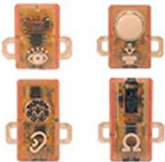
Figura 5 - Sensores para PicoCricket, de luz, de toque, de sonido y de resistencia.
