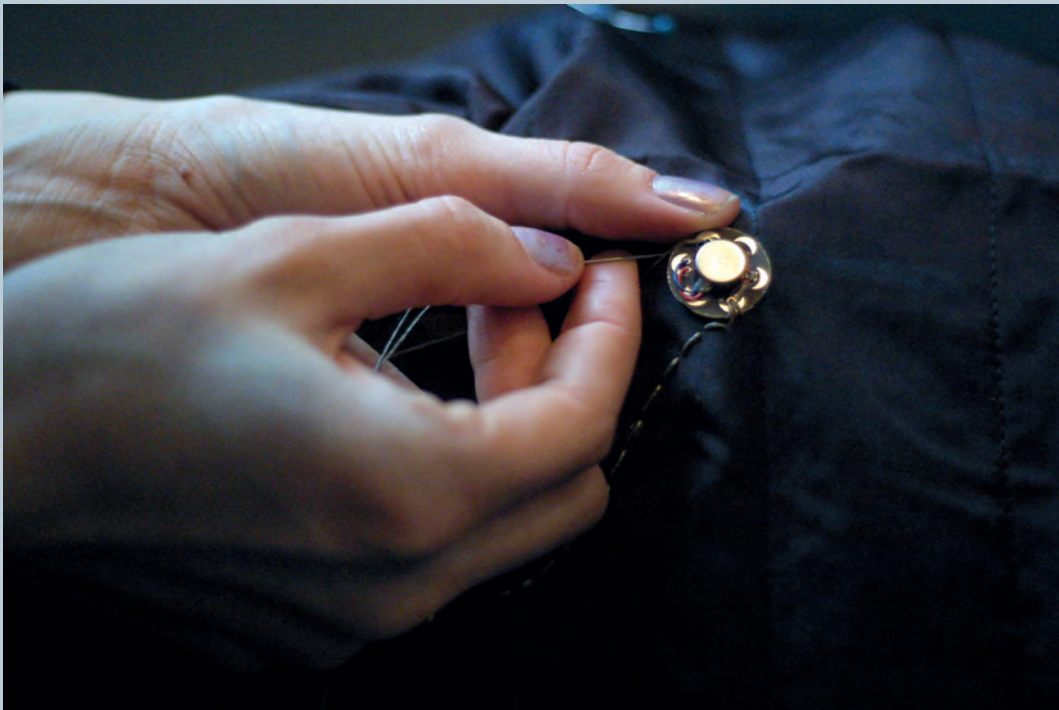
13. En plus des cartes microcontrôleurs Lilypad, Leah conçoit également toute une série de petites cartes intermédiaires appelées « circuits imprimés » : breakout boards permettant de connecter plus facilement des composants standards comme ici un vibreur. Ces dispositifs souples sont directement connectables dans la logique de déformation du vêtement, pliables et perçables – des caractéristiques uniques dans le monde de l'électronique habituellement rigide, déterminé et clos.
