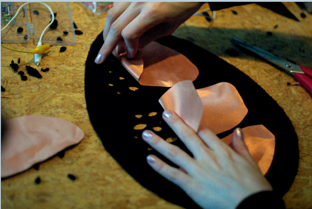
14. On voit ici la fabrication d'un capteur de contact rudimentaire à l'aide de flectron, un tissu similaire au zelt. Lorsque les deux parties sont pressées l'une contre l'autre, un contact électrique se forme. C'est une version géante d'un « capteur » de pression, un composant électronique habituellement issu d'un processus de fabrication industriel. Le textile électronique réinvente les composants à l'échelle de l'humain et non pas des machines qui les fabriquent.
