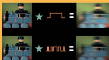
露出時間の間、物体が一方向に進んでいる場合には、時間軸に沿ったコンボリューションは、ブラーのかかっていない物体そのものの形を表す画像とコードとのコンボリューションとしてモデル化される。上が通常の撮影、下がコードに従ってシャッターの開閉し撮影を行った場合を示す
