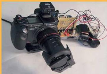
コーデッド・エクスポージャーカメラ。手前の液晶シャッターを開閉させてコードを作り出す。専用ドライバを内蔵することで、持ち運び可能となった
